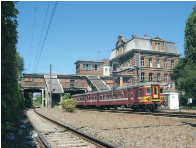
■ Figure 21 : la gare de Laeken, aujourd'hui désaffectée mais figurant au Plan Régional de Développement bruxellois comme point d'arrêt RER. Passage d'un train omnibus de banlieue exploitée avec une automotrice AM 65 typique du paysage ferroviaire belge et datant des années 1960. (photo F. D.)
